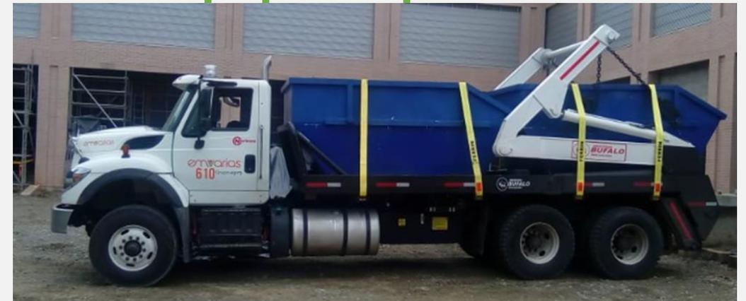
Prestación servicios en la Planta de tratamiento de aguas claras de EPM con el nuevo equipo Skip Loader para la remoción de residuos sólidos y arenas de decantación.
