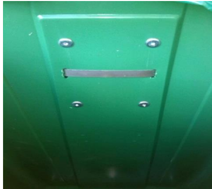
Vista interior del cuerpo de la cesta, con el soporte extra de zuncho
